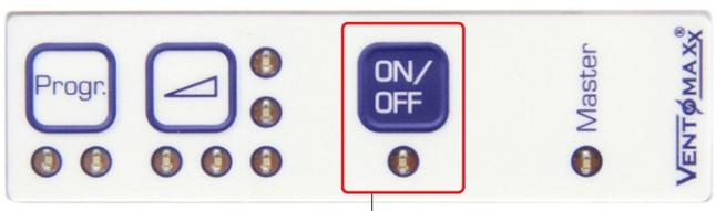
Drücken > 7 sek = Wechsel in den Konfigurationsmodus
