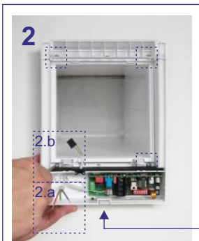
Design-Gehäuse an der Teleskopeinheit festschrauben
