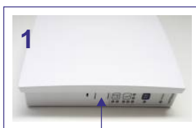
1 Entriegelung des Gehäuse- deckels drücken; Frontdeckel abnehmen
