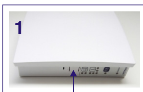
1 Entriegelung des Gehäusedeckels drücken; Frontdeckel abnehmen
