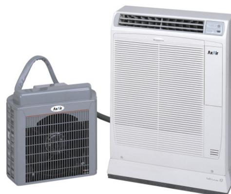
Mobiles Splitklimagerät mit einer Ausseneinheit, miteinander verbunden durch einen flexiblen Leitungsschlauch für Kältemittel, Kondensat und Steuerkabel. Die Temperaturerfassung kann entweder in der Fernbedienung oder im Klimagerät erfolgen. Dieses ist besonders bei Räumen von Vorteil, die ungleichmäßige Wärmequellen haben.
