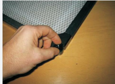
Öffnen des Filters durch Hochziehen der Clipverschlüsse
