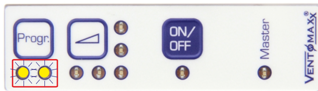
Filter-Wechsel Anzeige durch Blinken der LED
