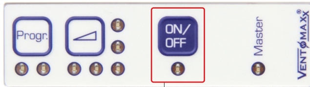
Drücken > 7 sek = Wechsel in den Konfigurationsmodus
