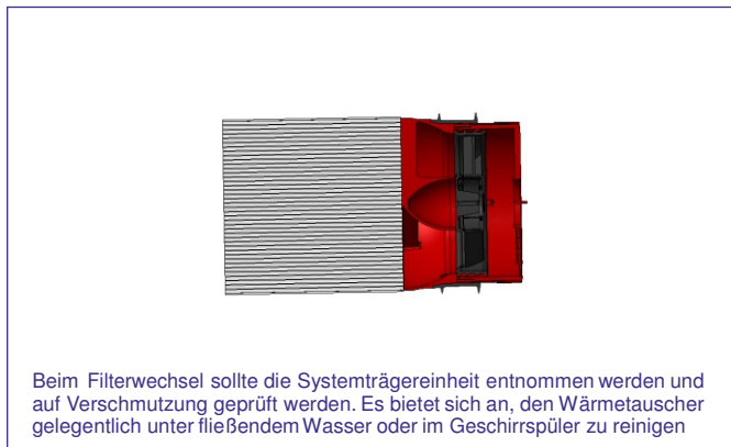
3 Filter in Aufnahme stecken; hinter beide Laschen klipsen
