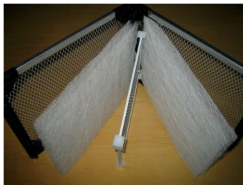
Filtermatten austauschen Wechselintervall: alle 3 Monate
