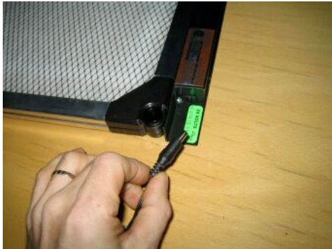
Entfernen des Stromanschlusses
